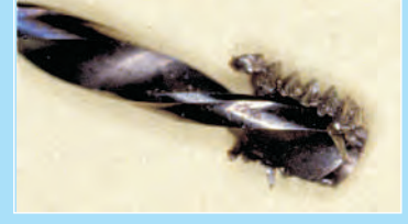
Mikromotor devri 2000 devir/ dakika'nın altına düşmemelidir.
