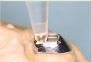
Döküm şapkanın temizlik ve tesviyesi esnasında raylı taban iç yüzeylerini aşındırmamaya özen gösterin. Uygun paralelleme kolunu kullanarak titanyum küresel kafanın kayar tabana sorunsuz ve hassas olarak takılıp sökülebildiğini kontrol edin.
