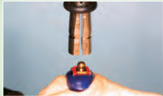
Raylı tabanın 3 yüzünü (4ncü tahliye yüzü hariç titanyum küresel kafanın sökülebilmeye için) mum ile kaplayarak mum modele bağlayın
